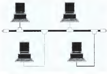
Figura 2. Una rete ethernet che utilizza l'accesso CSMA/CD utilizza un topologia a bus. Tutte le stazioni possono trasmettere in qualsiasi istante purché il canale sia libero poiché non richiedono di particolari abilitazioni.
